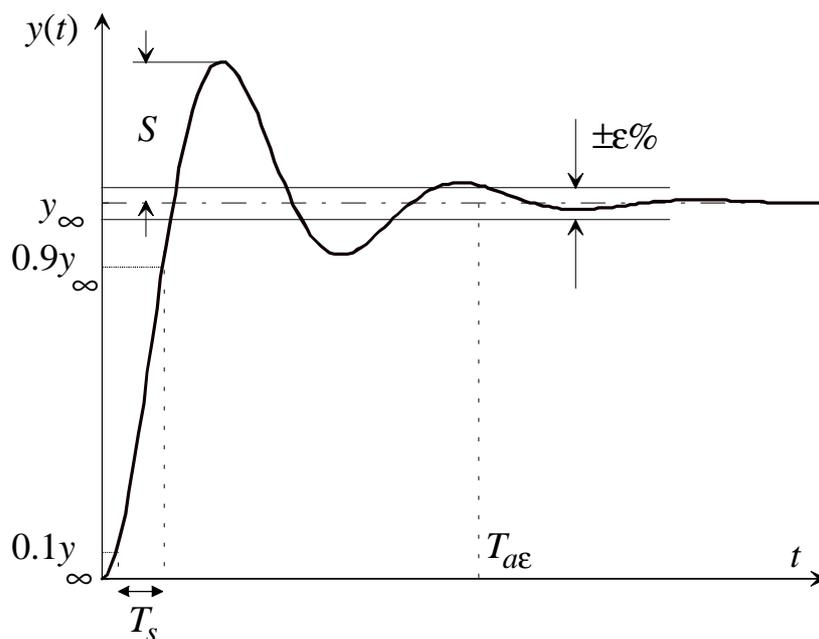
Fig. 1 : Parametri caratteristici della risposta allo scalino
