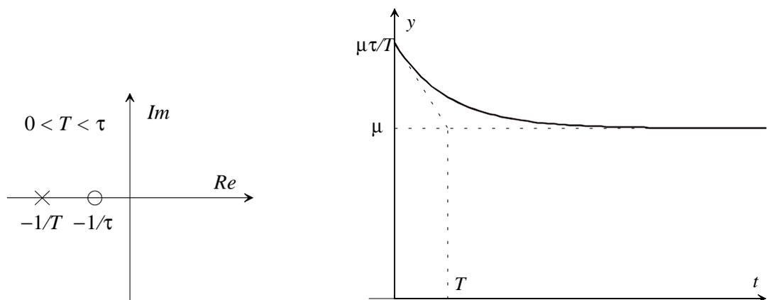
Fig. 8 : Risposta allo scalino per  $0 < T < \tau$
