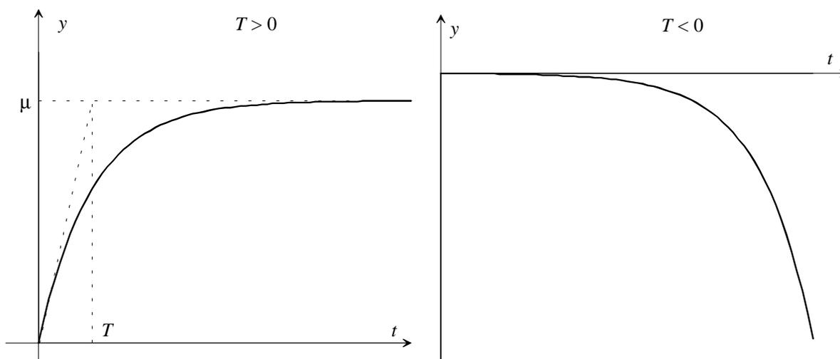
Fig. 2 : Risposta allo scalino per  $T > 0$  e  $T < 0$
