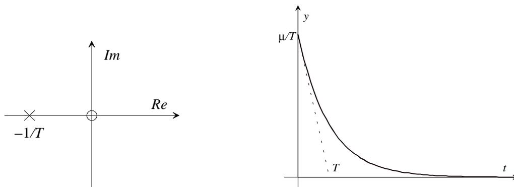
Fig. 12 : Risposta allo scalino (zero in  $s=0$ )
