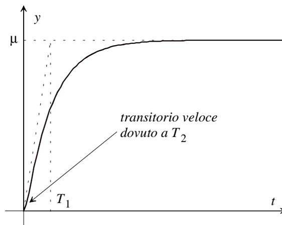
Fig. 14 : Risposta allo scalino con  $T_1 \gg T_2$
