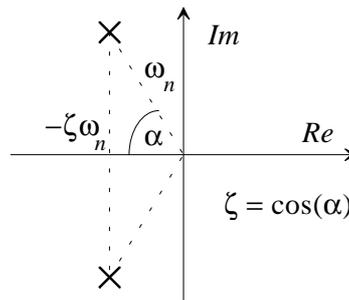
Fig. 17 : Significato dei parametri  $\zeta$  e  $\omega_n$
