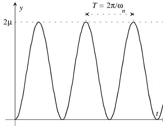
Fig. 18 : Risposta allo scalino per  $\zeta=0$
